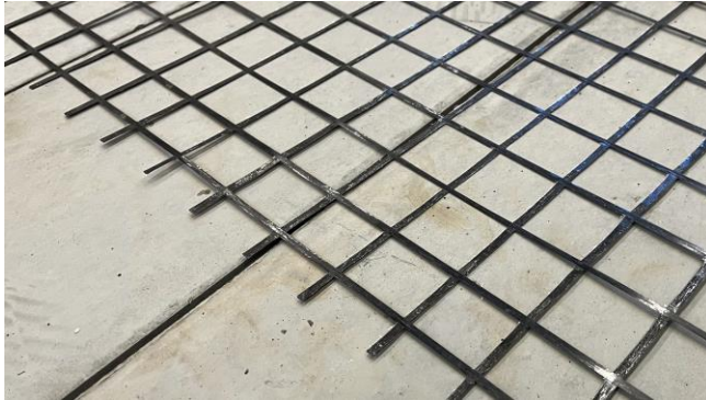
Verstärkungsgewebe aus Carbonfaser. Foto: Chalmers | Mia Halleröd Palmgren
