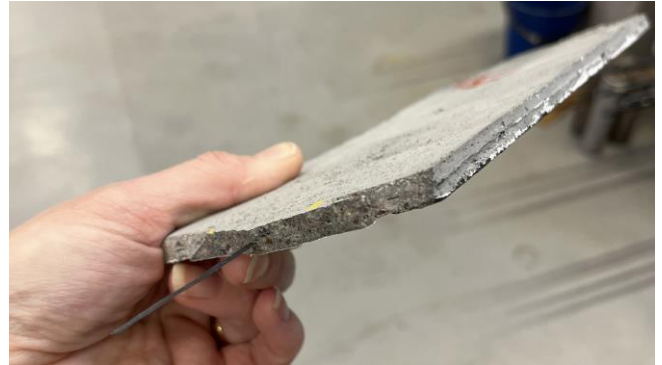
Beton mit eingebettetem Carbonfasertextil. Foto: Chalmers | Catharina Björk
