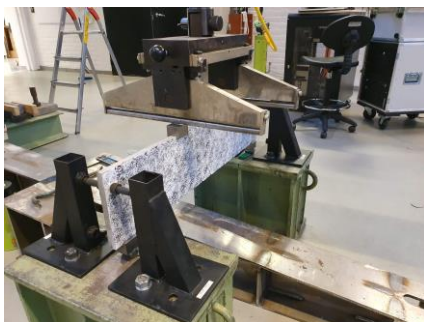
Testaufbau, bei dem textilbewehrter Beton im Konstruktionslabor bei Chalmers belastet wird. Foto: Chalmers | Catharina Björk
